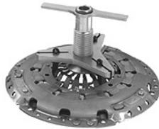
Нажимной диск сцепления с зажимным устройством
