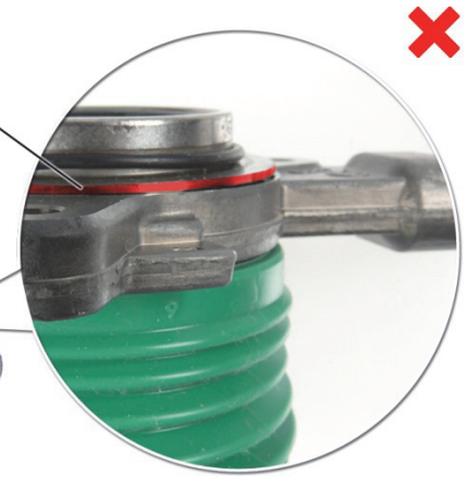
Рис. 3: Подвижная гильза выдвинута из зачеканки
