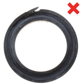
Рис. 7: Манжетное уплотнение (1) срезано
