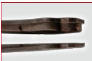
**ВНЕШНИЙ ВИД** Чрезмерный износ одной или нескольких колодок на одной оси
