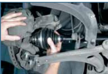
Вставьте приводной вал в корпус подшипника колеса. **ВНИМАНИЕ:** всегда используйте все прилагающиеся детали. Используйте инструмент, предписанный производителем. Проверьте прочную посадку шарнира.
