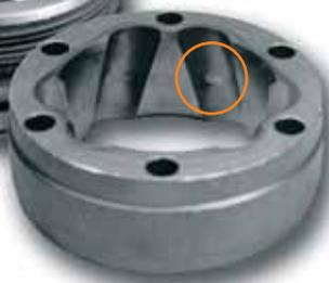
Сильно отполированные места с ямочками в канавках для шариков (0,5-1,0 мм).
