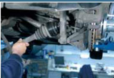
Извлеките приводной вал. Очистите до металлического блеска корпус подшипника и место крепления на дифференциале.
