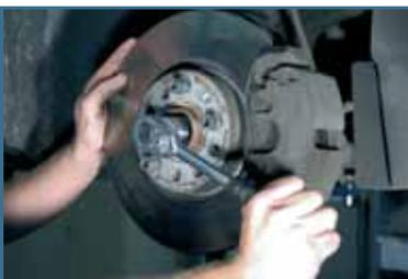
Наденьте фланец на резьбу внешнего шарнира. Затяните стопорный винт шарнира согласно предписаниям производителя автомобиля. **ВНИМАНИЕ:** используйте новые центральные винты! Смонтируйте колесо.
