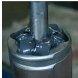
Для шариковых шарниров, шарниров «трипод», а также для других стандартных и подверженных высоким нагрузкам областей применения существуют различные смазочные материалы. Их состав отлично подходит для нанесения этих смазок на сталь шарнира и пыльник, что обеспечивает свободное от трения взаимодействие компонентов.
