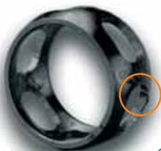
Следы износа (сколы материала) у внешних и внутренних контуров на внешних фиксированных шарнирах.
