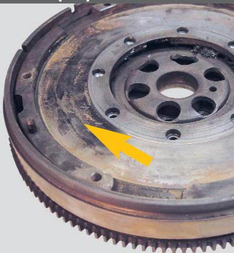
**Перегрев происходит вследствие неправильной эксплуатации сцепления, например, из-за буксования сцепления:**
