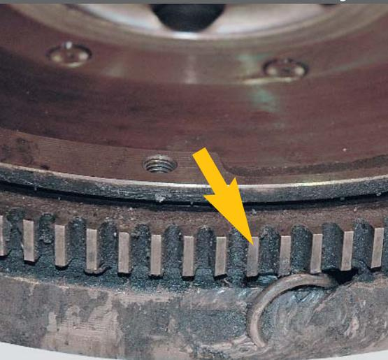
**Большая механическая перегрузка всего двухмассового маховика:**
